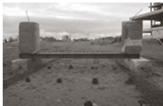
شکل (۹) چگونگی قرارگیری وزنه‌ها روی تیر آزمایش بارگذاری شمع
