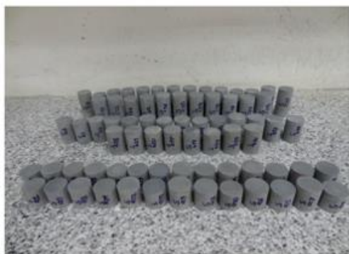
شکل (۵) نمونه‌های ماسه سنگ تهیه شده برای آزمایش هاپکینسون در سه نسبت منظر ۱، ۱٫۵ و ۲
