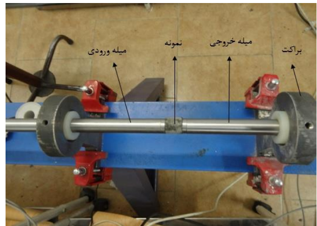
شکل (۷) نمایی از دستگاه هایپکینسون همراه با نمونه مورد آزمایش
